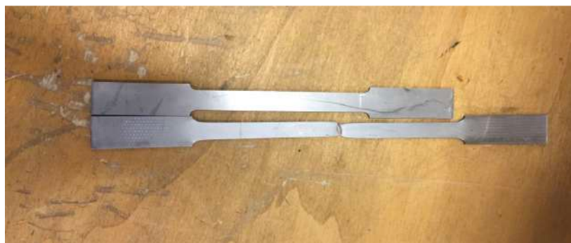
Figura 22 – Provete antes e após ensaio de tracção
