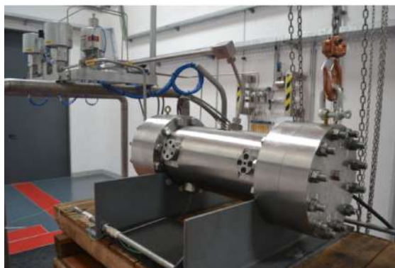
Figura 9 (a) Vista de corte do protótipo da câmara (b) câmara após fabricação
