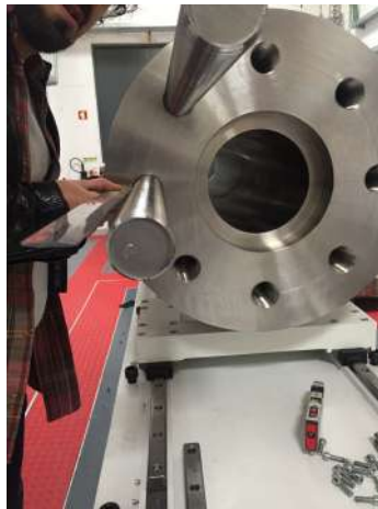
Figura 3 – Erro de fabrico nos furos da câmara de combustão
